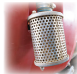
▲給水部分の割れがあるとゴミを吸い上げるため故障につながる
