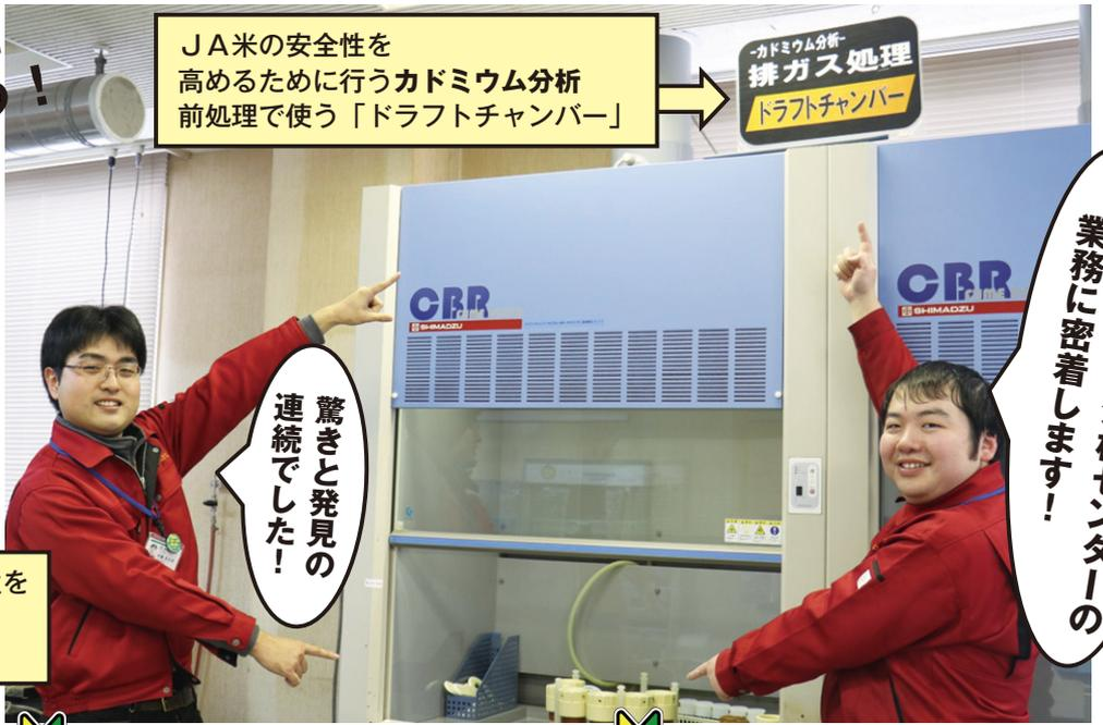
JA米の安全性を高めるために行うカドミウム分析前処理で使う「ドラフトチャンバー」
